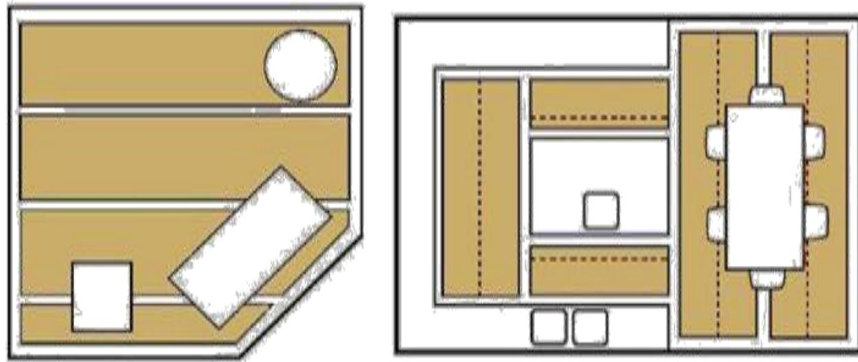
Сплошной карбоновый слой у **Термоплёнки «Russian Heat» HP APN-410** позволяет делать линии отреза произвольно и исключает образования холодных зон. Это очень удобно при монтаже в помещениях со сложной конфигурацией, а также позволяет обойти мебель любой формы.
